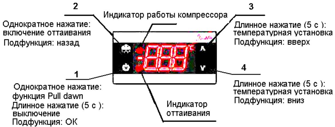
**Рисунок 4 – Электронный контроллер «DANFOSS»**
